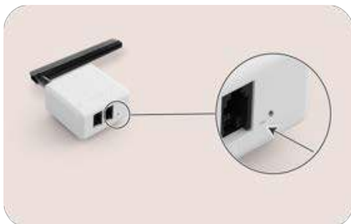
Afbeelding 28: positie van de led op de Smappee 4G Connect (antenne niet weergegeven)
