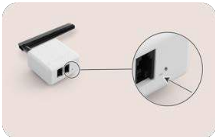
Afbeelding 33: positie van de led op de Smappee 4G Connect (antenne niet weergegeven)
