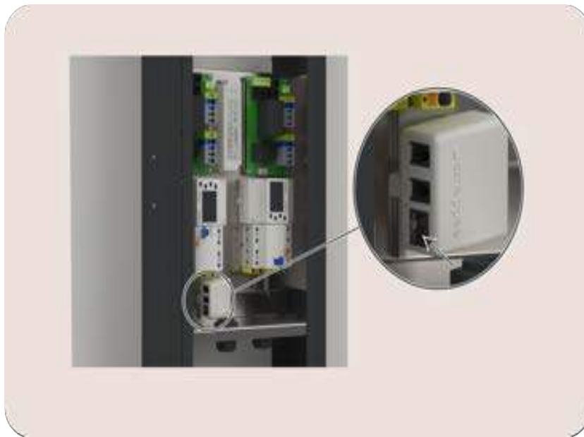
Afbeelding5: aanzicht op de RJ45-poort op de Connect
