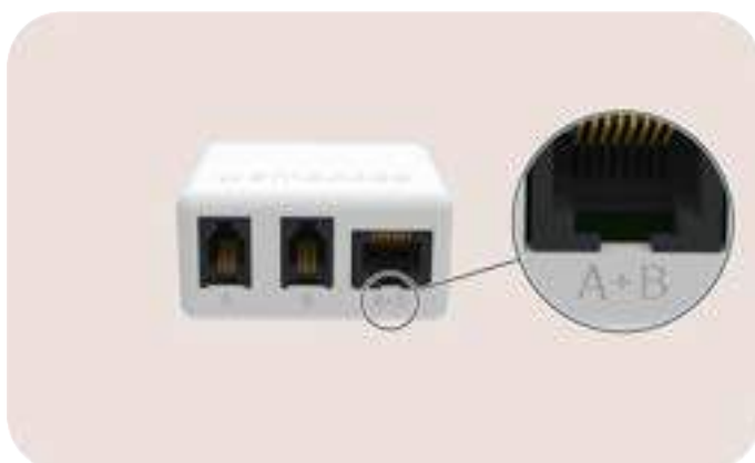
Afbeelding 13: aanzicht op de A+B-poort van de Smappee Splitter
